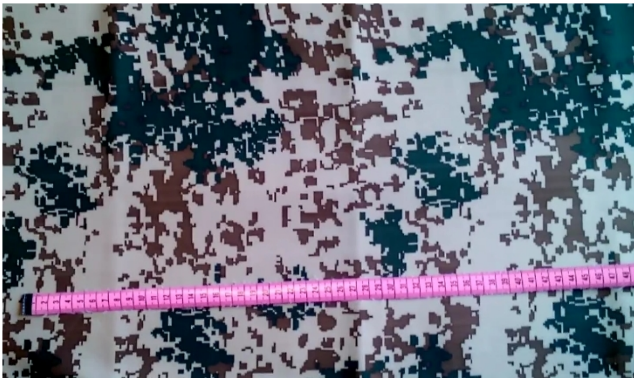
Фиг.П4.1. Маскировъчното разпетняване на калъфа на бронезилетката за зони с пустинен климат
